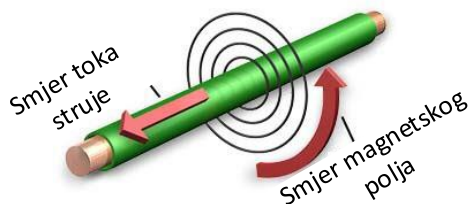
Slika 6.2. Magnetsko polje koje se formira oko vodiča
