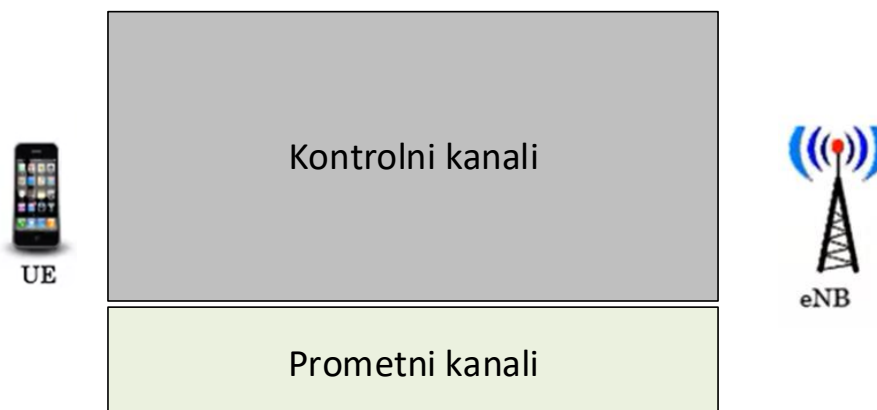
Slika 4.22. Podjela kanala na logičkoj razini
