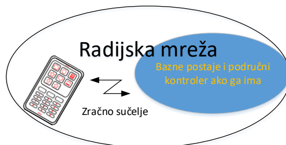
Slika 2.1.2. Radijska mreža sa svojim osnovnim dijelovima
